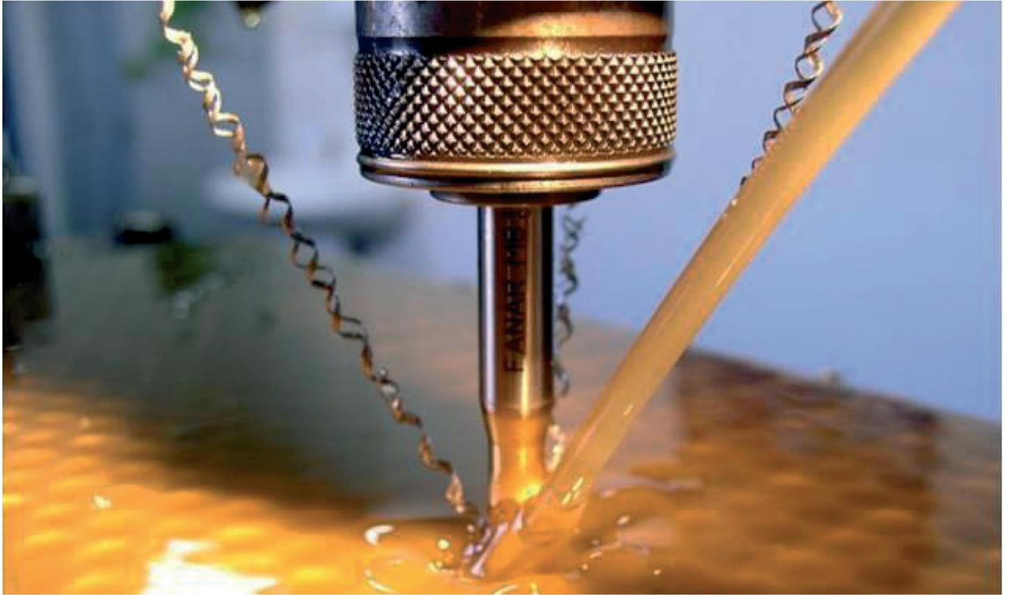
螺纹作为最后一个加工步骤有着特殊意义：因为螺纹缺陷可以导致之前的努力前功尽弃。因此，稳定和可靠的工艺至关重要。“对此，A 和 O 是高品质的螺纹钻头，具有低摩擦且同时摩擦学性能良好的涂层”，FANAR 技术主管 Dariusz Ptaszkiewicz 说道。“因此，CemeCon 光滑且无液滴的溅射涂层是我们螺纹钻头的第一选择。”
