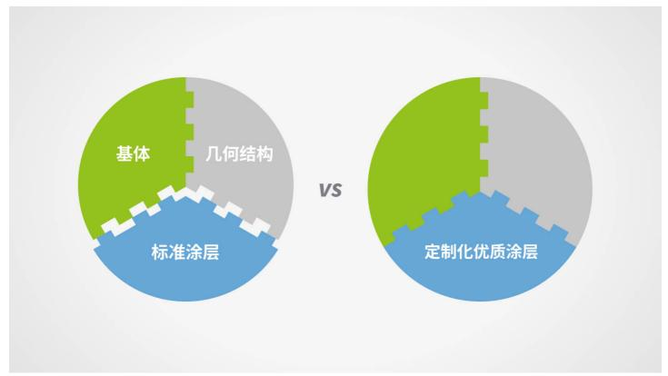
标准解决方案的适用范围很窄。如果所有组件—基底、几何形状和涂层—都完美匹配,输出的结果必然 就是出色的精密刀具,机械师可以用它来实现最高性能
