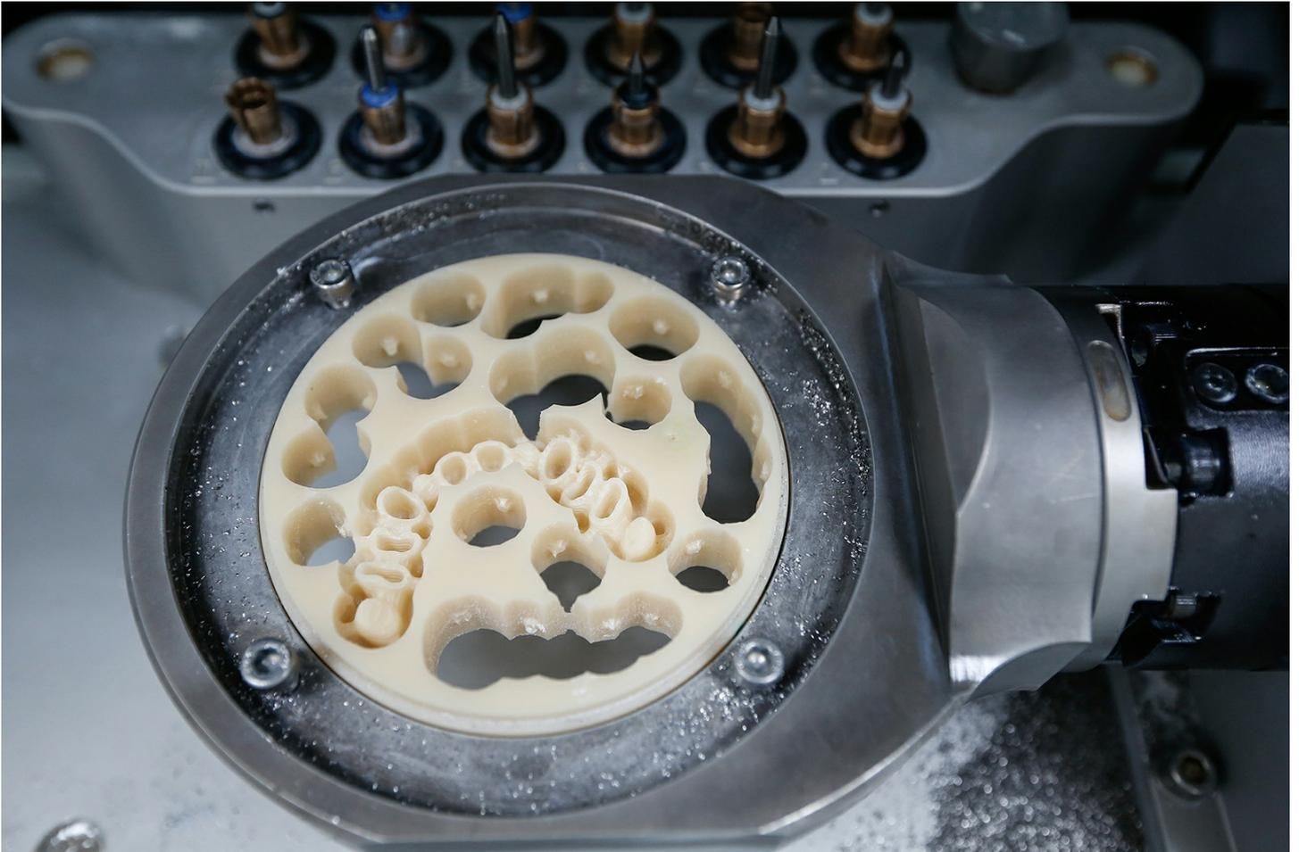
Als so genannter Grünling – vor dem Brennen der Keramik – ist Zirkonoxid hochabrasiv und zugleich relativ porös. Die Bearbeitung ist eine Herausforderung an die Verschleißfestigkeit von Zerspanwerkzeugen.
