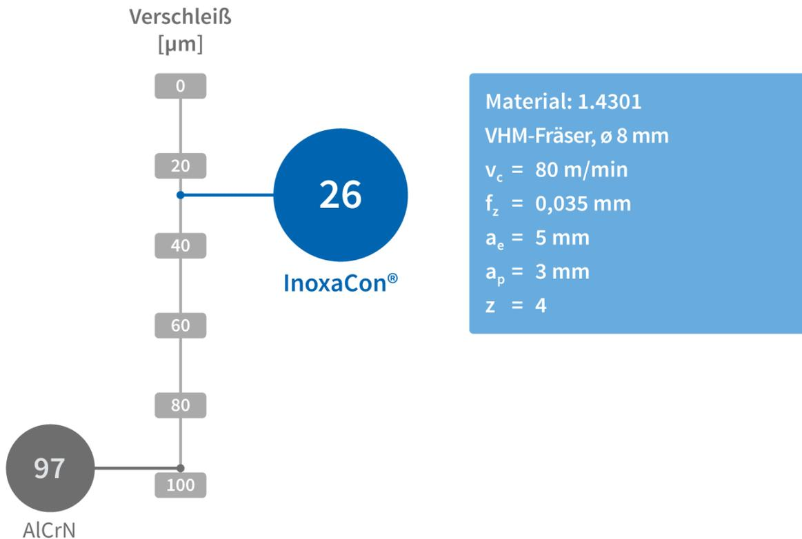
Ein Praxisbeispiel im Vergleich mit AlCrN untermauert die Leistungsfähigkeit des HiPIMS-Schichtwerkstoffs.
