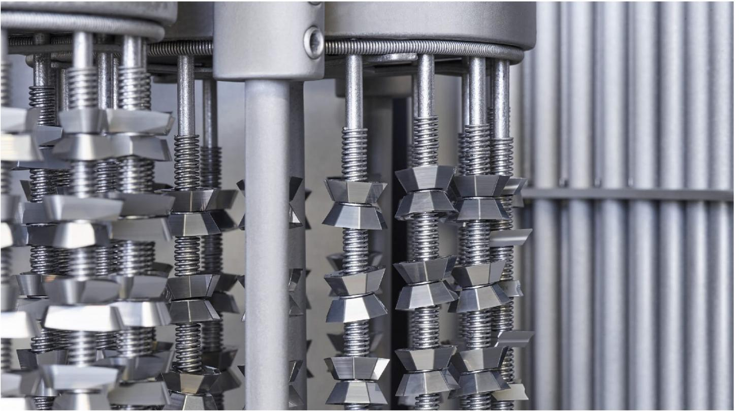
CemeCon-Premium-Beschichtungen sind spezifisch entsprechend Werkzeuggeometrie und -werkstoff sowie für die jeweilige Zerspanaufgabe ausgelegt.
