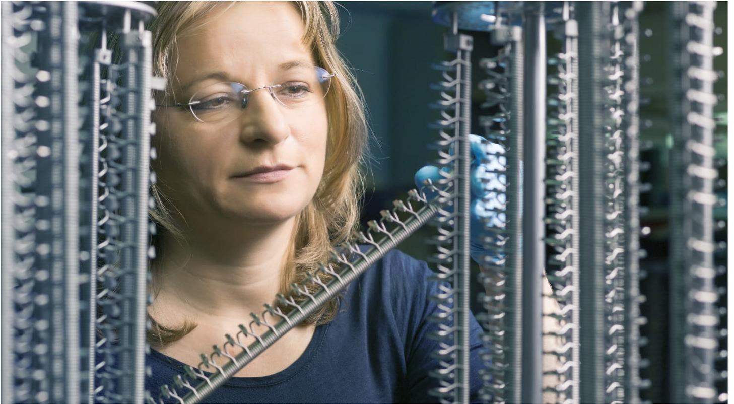
Bei CemeCon werden Wendeschneidplatten immer als individuelle Charge beschichtet – für Schaftwerkzeuge steht eine eigene Produktionslinie im Beschichtungszentrum bereit.
