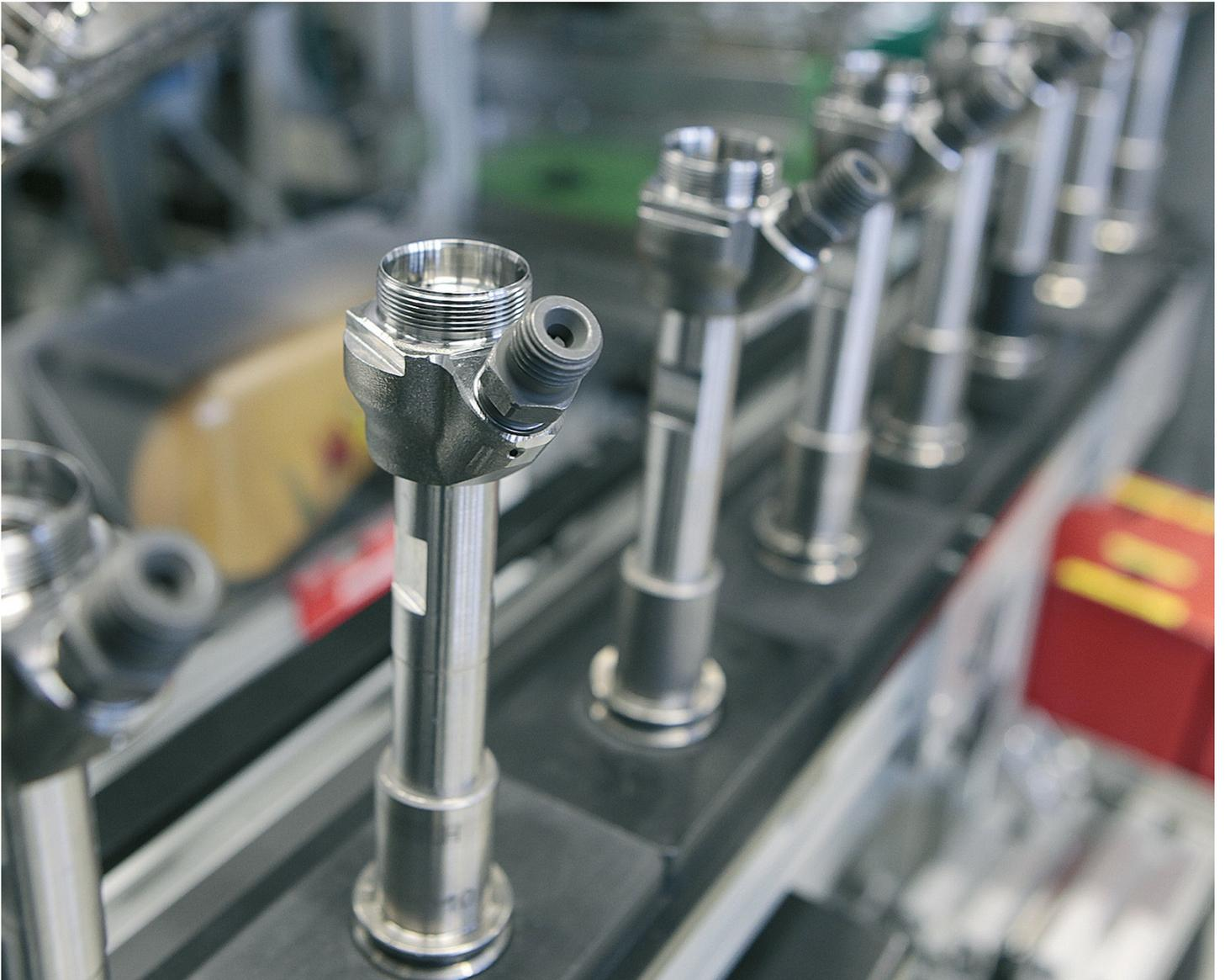
Mit HiPIMS konnte Bosch bei der Fertigung von Common Rail Injektoren höhere Bauteilqualität bei gesteigerter Prozesssicherheit erreichen.
