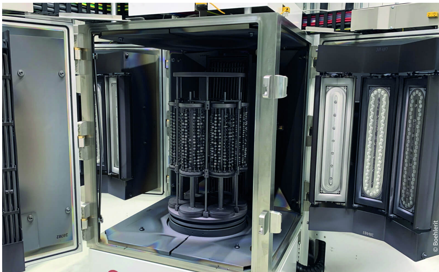
Die CC800 ® HiPIMS-Beschichtungsanlage bei Boehlerit im Einsatz
