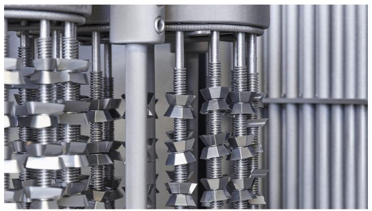
Les revêtements Premium CemeCon sont spécialement conçus en fonction de la géométrie et du matériau de l'outil, mais aussi de la tâche d'usinage à réaliser.
