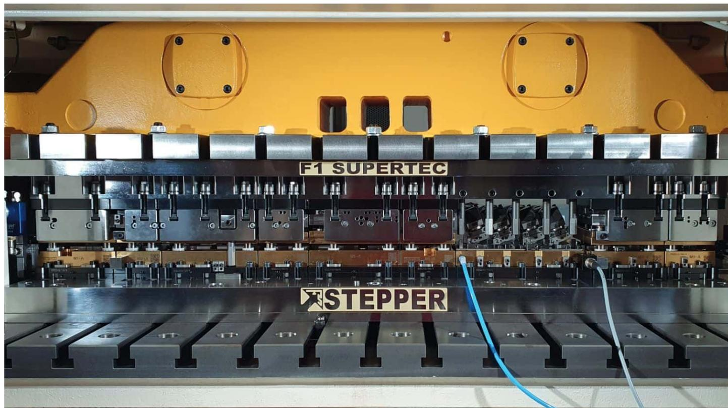
Les matrices progressives modulaires de Stepper peuvent contenir plus de 1 000 pièces actives mobiles revêtues de PVD, telles que des poinçons de découpe, des inserts de découpe, de pliage et de gaufrage. Une usure excessive de l'une de ces parties actives affectera la qualité du produit. Grâce à la technologie HiPIMS, Stepper peut prolonger considérablement les intervalles de maintenance requis (généralement jusqu'à plus de 10 million de cycles sans intervention de maintenance).
