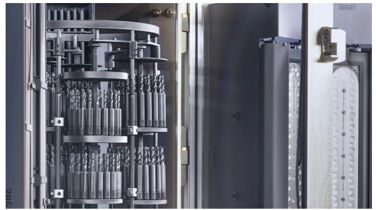
Accusharp a pu augmenter la durée de vie des outils de précision de 50 à 80 % avec les revêtements HiPIMS, en fonction de l'application.
