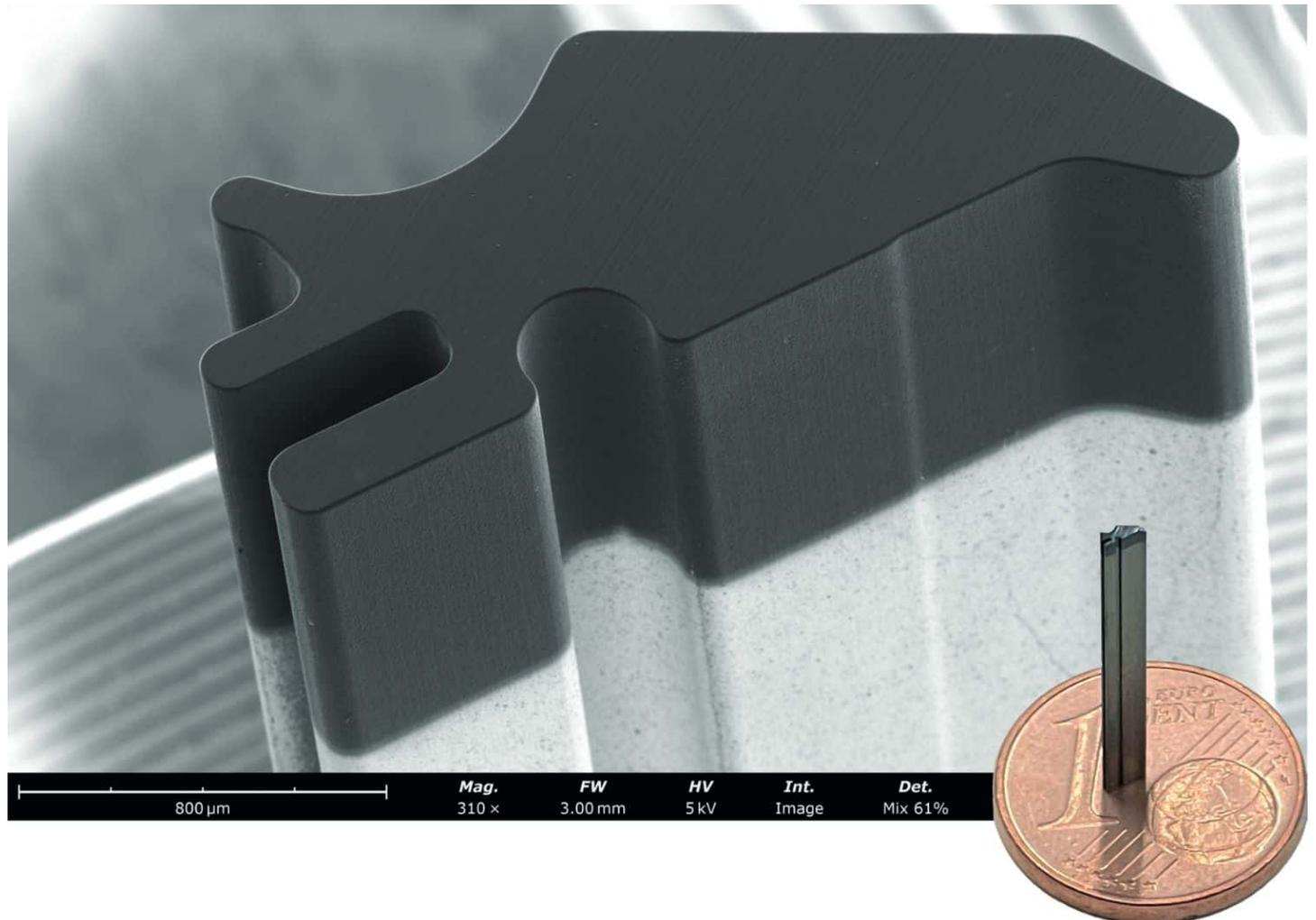
Mit der HiPIMS-Technologie lässt sich die filigrane Geometrie des Schnittstempels optimal beschichten (Fotos: Stepper)
