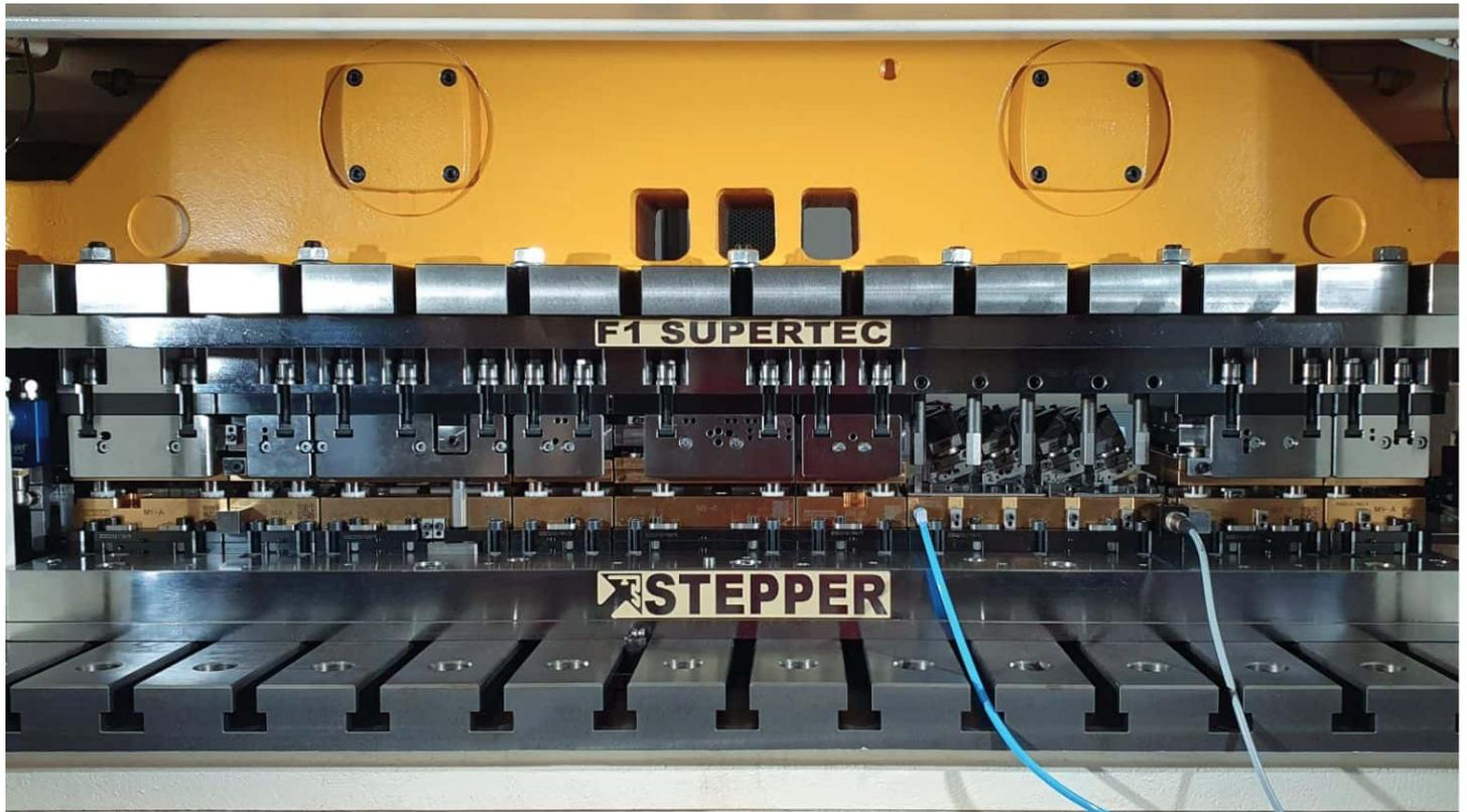
In modularen Folgeverbundwerkzeugen von Stepper können über 1.000 PVD-beschichtete bewegte Aktivteile, wie Schnittstempel, Schnitt-, Biege- und Prägeeinsätze, verbaut sein. Zu hoher Verschleiß an einem einzigen dieser Aktivteile beeinflusst die Produktqualität. Mit der HiPIMS-Technologie kann Stepper erforderliche Wartungsintervalle signifikant (typisch auf weit über 10 Mio. Stanzhübe ohne Wartungseingriff) verlängern.
