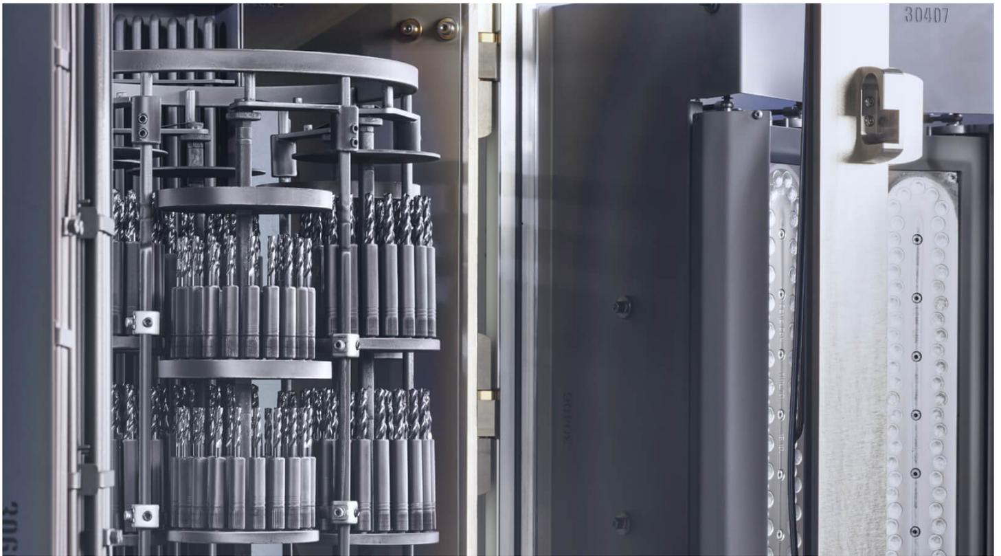
Accusharp konnte mit den HiPIMS-Beschichtungen die Standzeiten der Präzisionswerkzeuge je nach Anwendung um 50 bis 80 Prozent steigern.
