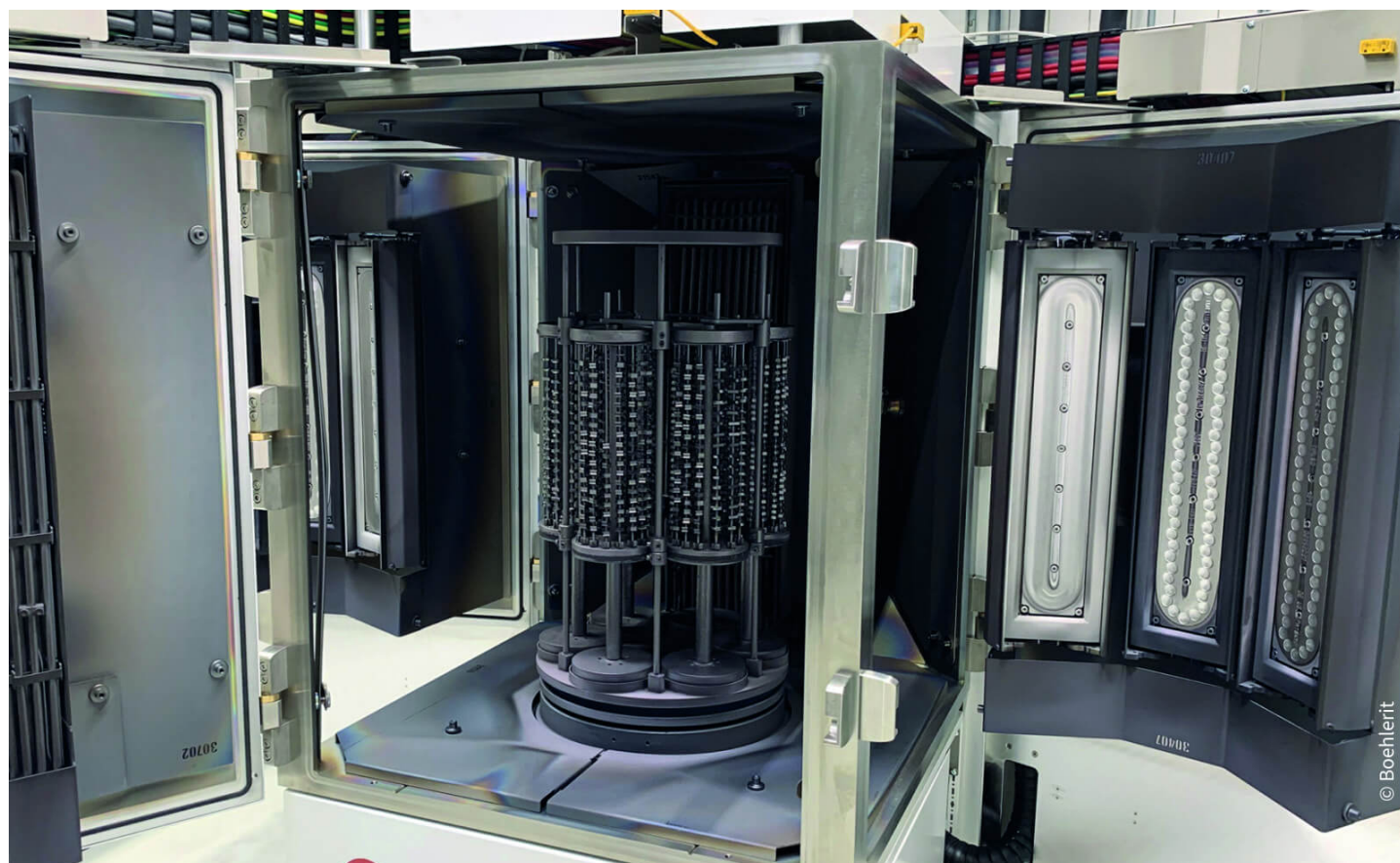
Boehlerit社で使用されているCC800 ® HiPIMSコーティングシステム
