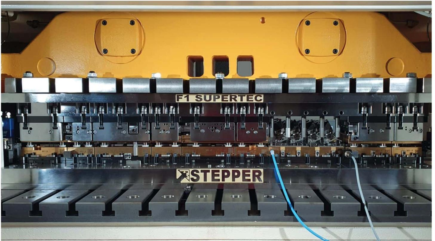
Stepper의 모듈식 프로그레시브 다이는 펀치 절단, 절단, 밴딩 및 엠보싱 인서트와 같은 1,000개 이상의 PVD 코팅이 된, 액티브 활성 부품을 통합할 수 있습니다. 이러한 활성 부품 중 하나가 과도하게 마모되면 제품 품질에 큰 영향을 미칩니다. HiPIMS 기술을 사용하여 Stepper는 필요한 유지 보수 간격을 크게 늘릴 수 있었습니다. (보통 1,000만 회를 넘는 펀치 스트로크까지는 유지 보수가 필요 없습니다.)
