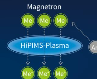
Die Leistungspeaks des HiPIMS Verfahrens bilden ein hochenergetisches Plasma, das die abgeschiedenen Materialien in bislang unerreichtem Maße ionisiert. Der hohe Fluss hochionisierter Partikel bildet sehr dichte und nahezu amorphe Schichtstrukturen.
