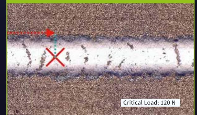
Die hohe Metallionisierung sorgt für beste Haftung. Eine Scratchlast von 120 Newton ist z.B. für die Silizium-dotierte – und damit sehr harte – InoxaCon® Schicht ein außerordentlicher Wert. Das auf AlTiN basierende Produkt FerroCon® erzielt bis zu 130 Newton. Dies ermöglicht die Zerspanung schwierigster Materialien.
