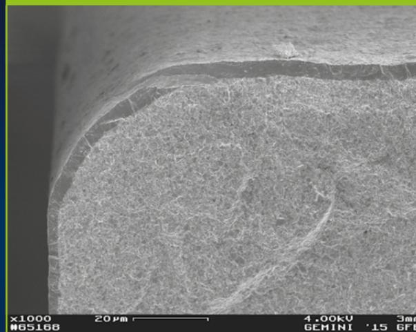
Die hohe Ionisation ermöglicht den Aufbau dichter, kompakter Beschichtungen, die gleichzeitig sehr hart und zäh sind. Mittels der HiPIMS-Technologie wachsen abgeschiedene Beschichtungen extrem homogen. Auch sehr komplexe Werkzeug-Geometrien werden rund um die Schneidkante homogen beschichtet.
