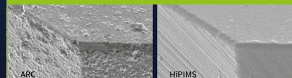
Im Gegensatz zu Droplets auf der Oberfläche bei anderen Verfahren (hier ARC) sind bei dem HiPIMS Verfahren die Oberflächen extrem glatt.
