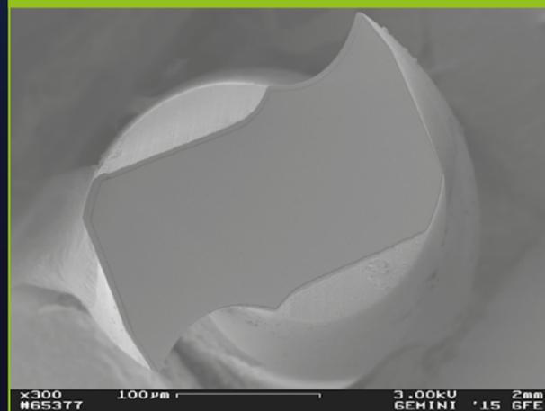
Defektfrei und ohne Antenneneffekte. Das HiPIMS-Verfahren kann auch bei sehr kleinen Geometrien eingesetzt werden, da es weder störende Droplets erzeugt noch die Schneidkanten schädigt oder verundet.
