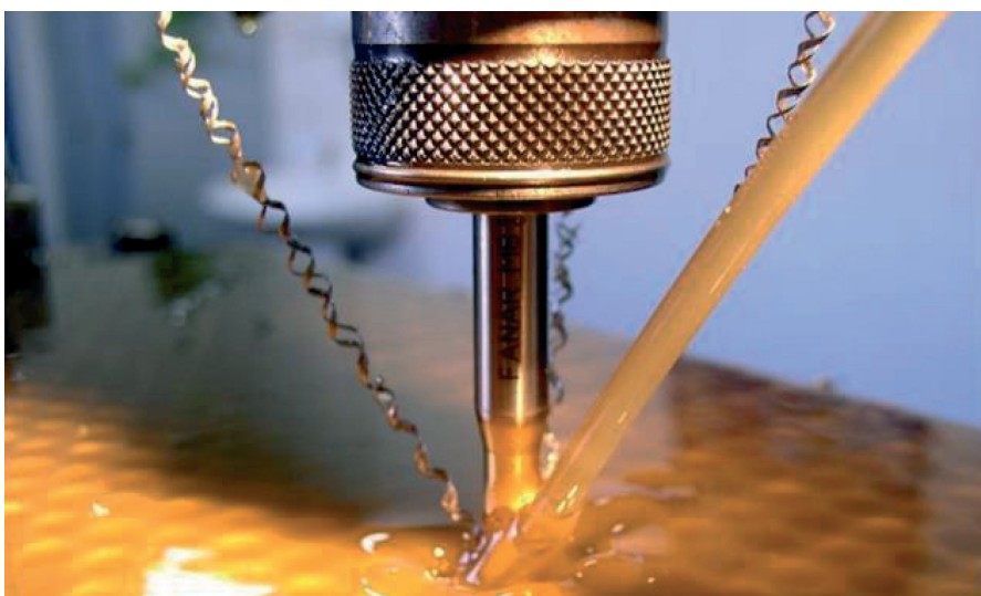
Die Fanar TN-Beschichtung – eine dropletfreie Sputterschicht – eröffnet dem Anwender neue Möglichkeiten beim Gewindebohren. (Foto: FANAR)
