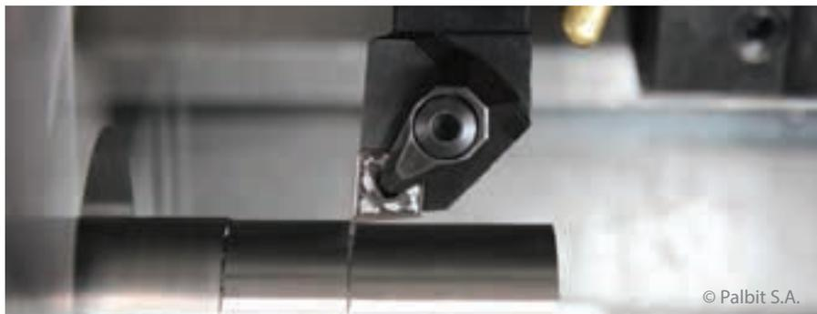
Beim Zerspanen von Titan und Superlegierungen profitiert Palbit von der Performance der neuen nanostrukturierten Beschichtungen von CemeCon.
