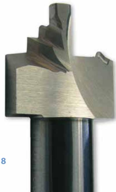
das Unternehmen auch unterschiedliche Beschichtungen für die Werkzeuge. Ludwig Hoferer: „Mit InoCon® auf Bohrern mit Durchmesser von 4 bis 25 mm konnten wir bei der Bearbeitung von rostfreiem Stahl (1.4301, 1.4305) die Standzeit teilweise um den Faktor 6 bis 8 gegenüber einer herkömmlichen TiAlN-Beschichtung steigern. Besonders beim Schneiden von feinen Konturen erzielten wir mit der HiPIMS-Schicht hervorragende Ergebnisse.“
