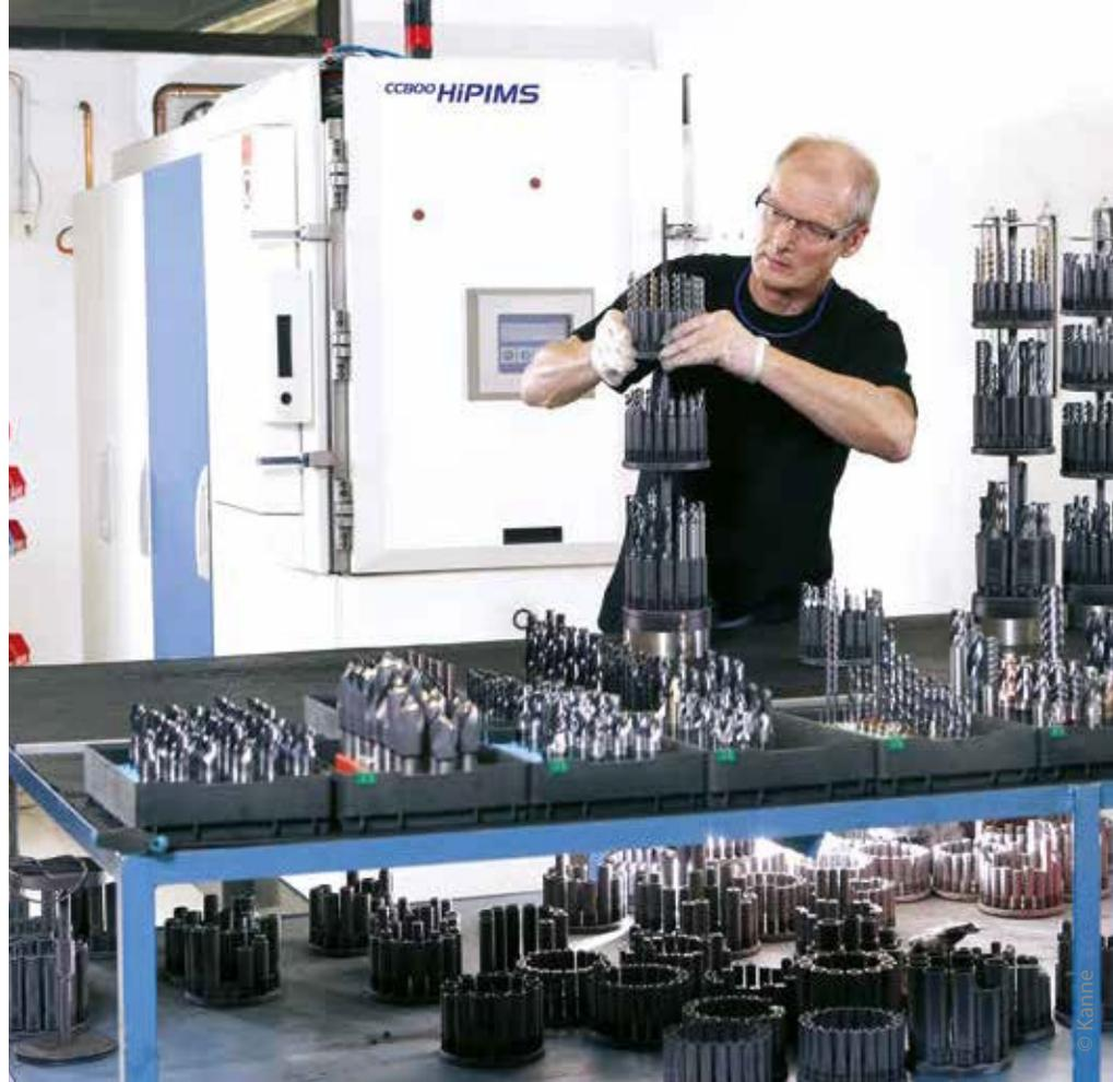
Kanne Premiumwerkzeuge bietet die komplette Fertigungskette aus einer Hand – vom Nachschliff bis zur Beschichtung.
