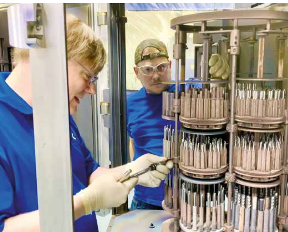
Das Handling ist ganz einfach: Scott Para (links) und Brandon Wilkins beim Beladen der Beschichtungskammer.
