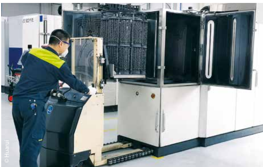
Huarui setzt seit Langem Sputteranlagen zum Beschichten ein. Um die Performance der Wendepplatten weiter zu steigern, investiert Huarui nun in eine CC800® HiPIMS.
