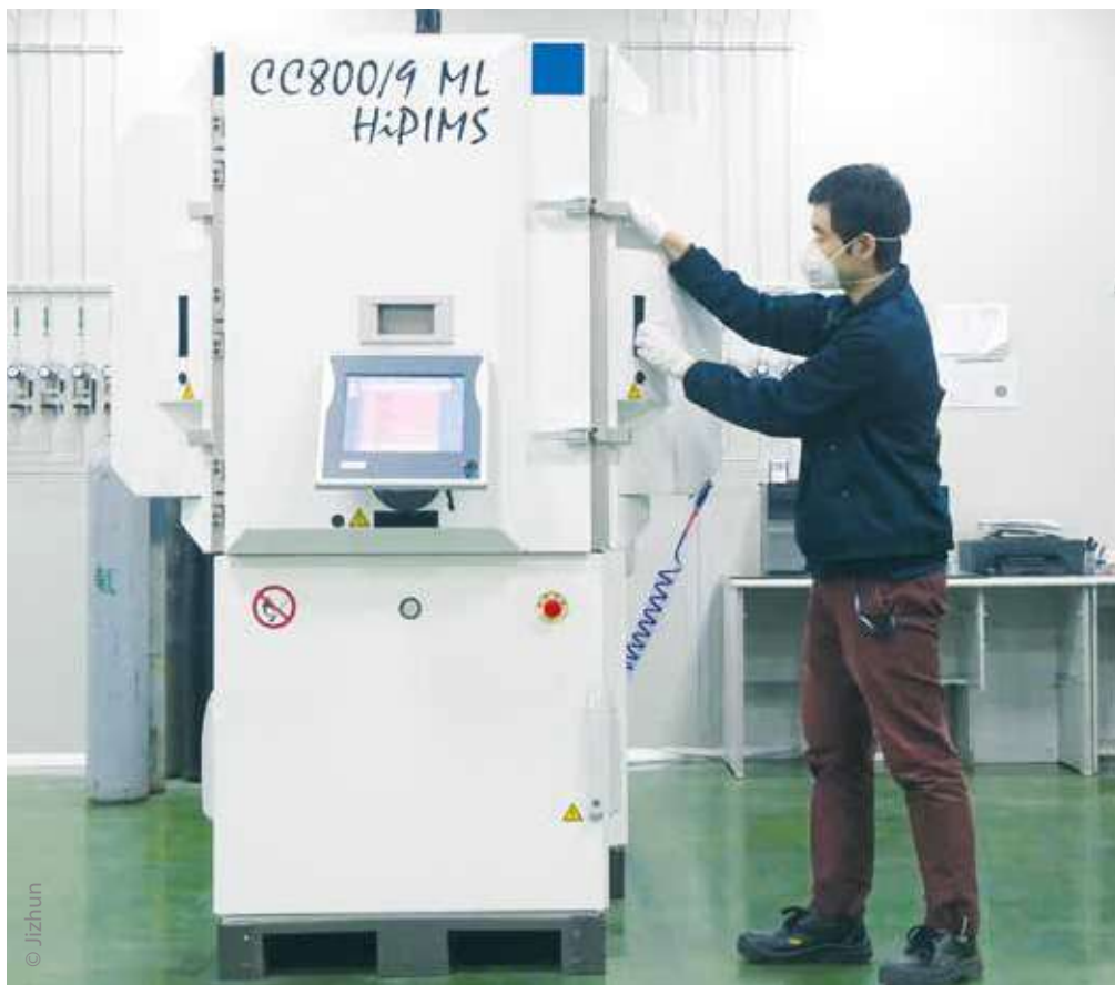
CC800/9 ML HiPIMS沉积高硬度、高强度和高抗氧化性以及高附着性的优质涂层
