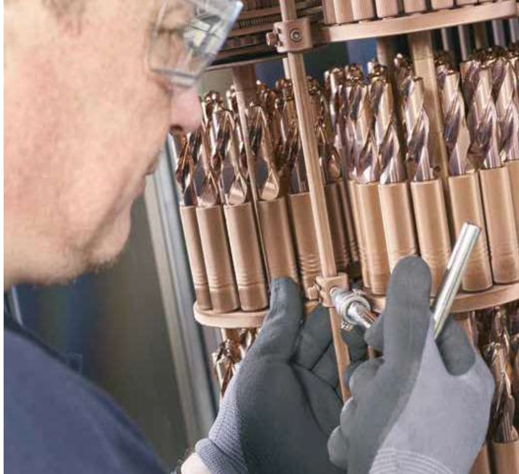
不锈钢钻孔，InoCon涂层钻孔数量是TiAlN涂层钻孔数量的六倍
