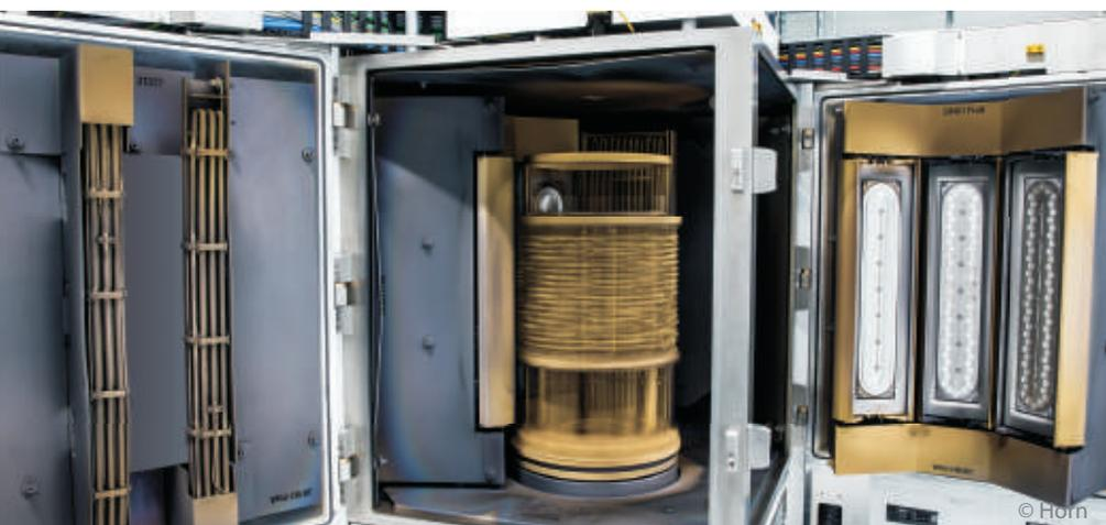
个用于新涂层研发的理想平台，而且也是一个真正的生产型设备。它具有中等规模的装炉量，涂层沉积速率可达到 $2\ \mu\text{m/h}$ ，同时还保证在严格的公差范围内。在很短的时间内可转换为其它任何涂层材料或适用于不同的刀具数量。此外，该系统可自动运行且维护费用低。是实现高生产效率的保证。”
