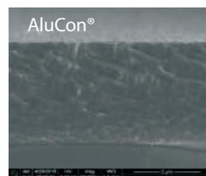
SEM图片对比的很清楚：HiPIMS工艺生产的AluCon®涂层有更加精细的结构和更优的涂层性能
