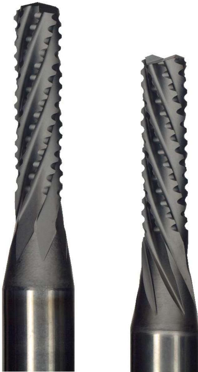
新型微型铣刀“HPTec复合刀具组合”（顺铣切几何形状；逆铣切几何形状）可精确适应纤维复合材料加工。其重要的组成部分是基于CC Dia® AeroSpeed®的金刚石涂层。
