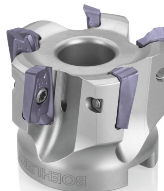
„Früher galt: PVD zum Fräsen, CVD zum Drehen. Die **HiPIMS-TECHNOLOGIE** änderte das schlagartig. Mit ihr sind heute **SCHICHTDICKEN** bis zu **12 µm** realisierbar. Das ermöglicht einen erfolgreichen Einsatz in **ANSPRUCHSVOLLEN DREHPROZESSEN.**“
