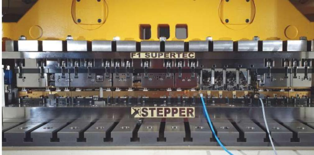
Stepper的模块化级进模具可以包含1,000多个PVD涂层活动零件，如切割冲头、切割、弯曲和压花刀片。这些活动部件中任何一个过度磨损都会影响产品质量。借助HiPIMS技术，Stepper可以显著延长所需的维护间隔（通常在不进行维护干预的情况下，冲床冲程超过1000万次）。
