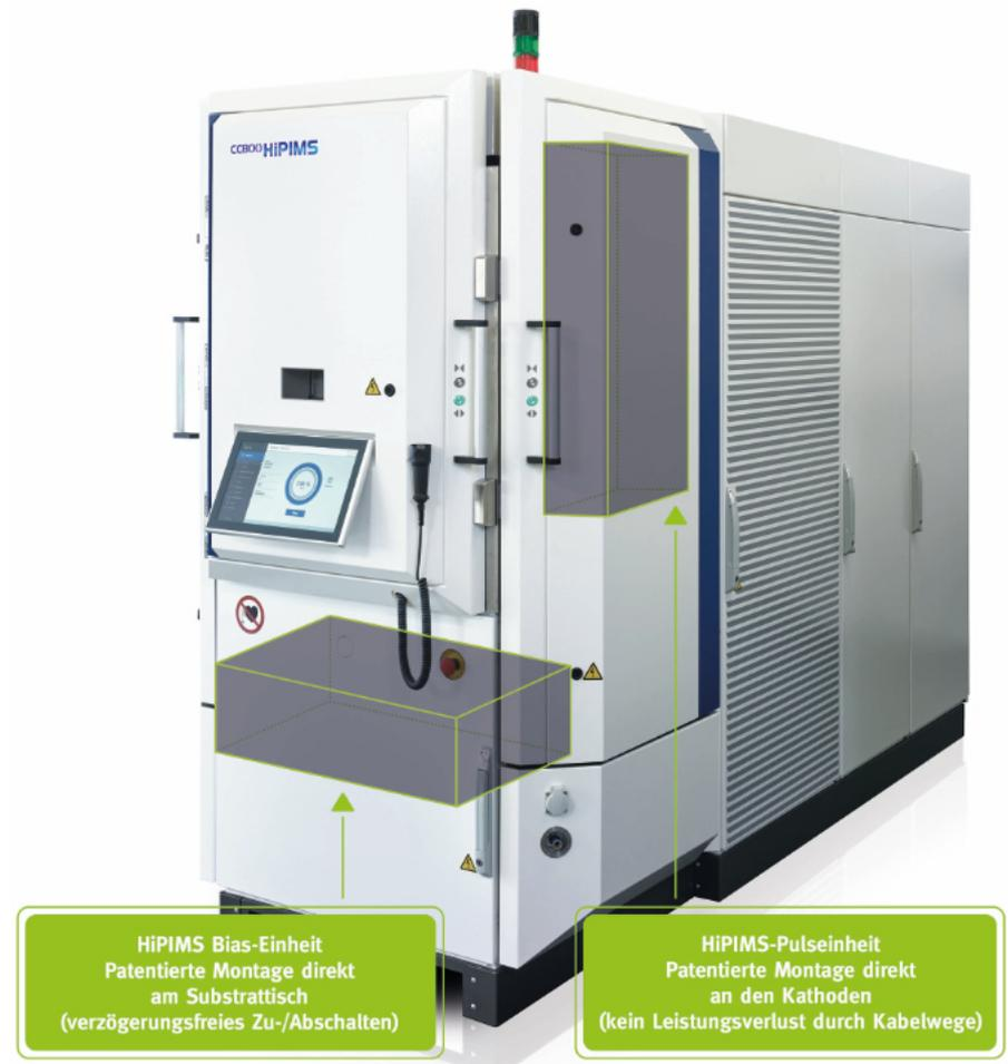
Volle Leistung ins Plasma durch verlustfreie Energiezufuhr
