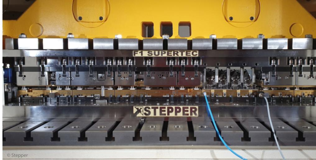
In modularen Folgeverbundwerkzeugen von Stepper können über 1.000 PVD-beschichtete bewegte Aktivteile, wie Schnittstempel, Schnitt-, Biege- und Prägeeinsätze, verbaut sein. Zu hoher Verschleiß an einem einzigen dieser Aktivteile beeinflusst die Produktqualität. Mit der HiPIMS-Technologie kann Stepper erforderliche Wartungsintervalle signifikant (typisch auf weit über 10 Mio. Stanzhübe ohne Wartungseingriff) verlängern.
