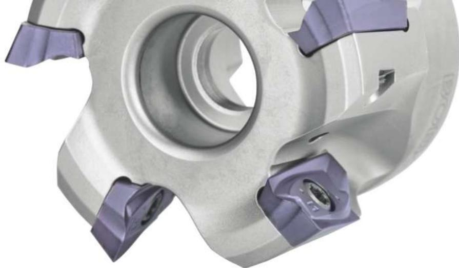
但是，为什么使用 CemeCon HiPIMS 技术可以实现以前无法想象的涂层厚度呢？秘密在于：HiPIMS 阴极脉冲与基体偏压的同步（CemeCon 独有技术），可以主动地对涂层残余应力进行管理并将其保持在较低水平。由于 CVD 技术产生拉应力，因此，该涂层工艺不适应于铣削刀具。FerroCon® Quadro 凭借低残余应力管理不仅可实现高达 12 μm 的涂层厚度，测试表明，凭借卓越的技术，甚至还可以实现高达 25 μm 的
