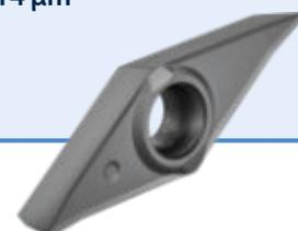
Speziell positive Wendeschneidplatten-Geometrien mit Bohrung lassen sich besonders wirtschaftlich mit Diamant beschichten. Die Spanformgeometrie wird nicht verändert, da die Diamant-Beschichtungen unmittelbar auf der Substratoberfläche aufwachsen und so die Geometrie exakt abbilden. Zudem ist eine diamantbeschichtete Hartmetall-Schneidkante stabil und sehr robust. Das ermöglicht hohe Vorschübe und ist vor allem bei der Schruppbearbeitung von Vorteil.
