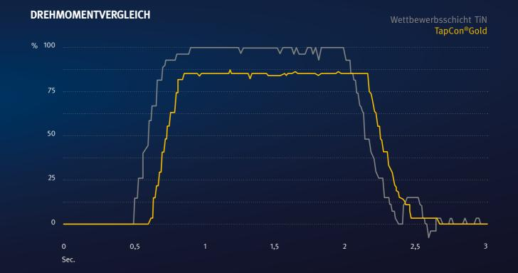
Ein stabil niedriges Drehmoment ist enorm wichtig für die prozesssichere und wirtschaftliche Gewindeherstellung. Der neu entwickelte HiPIMS-Schichtwerkstoff TapCon®Gold wurde genau auf diese Anforderungen zugeschnitten und ist die ideale Beschichtungsgrundlage für HSS-Gewindebohrer und -former.
